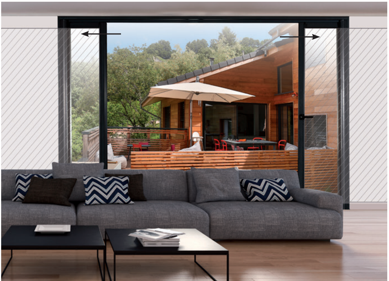
Partie du galandage rentrée dans le mur pour une ouverture totale
